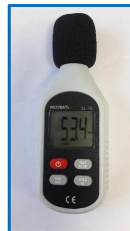
Un sonomètre pour mesurer le bruit dans les différents lieux de l'établissements et construire une échelle de bruit de l'établissement
