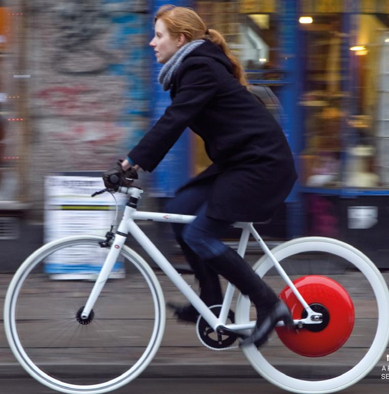
« La roue de Copenhague » transforme le vélo ordinaire en vélo électrique connecté, muni de capteurs sensoriels transmettant une série de données.
